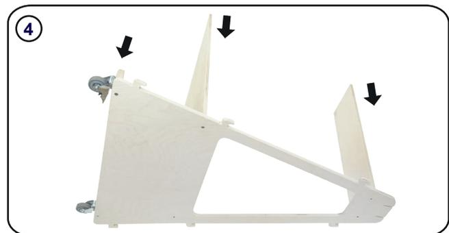
An ein Seiten-Element **K** wird das fertige Rollenbrett (aus Schritt 1) sowie die Zwischenbretter **I** und **J** mit den Schrauben **L** angeschraubt.
