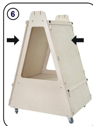
Die 2 Front-Elemente **E** (aus Schritt 2) anbringen.
